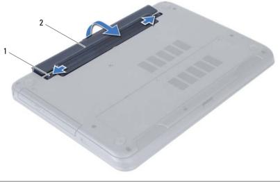
1 Pestillos de la batería (2) 2 Batería
