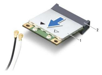
1 Minitarjeta inalámbrica 2 Conector de la placa base
