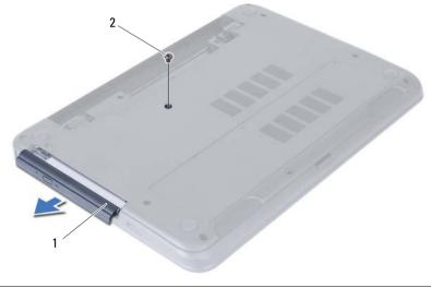
1 Ensamblaje de la unidad óptica 2 Tornillo
